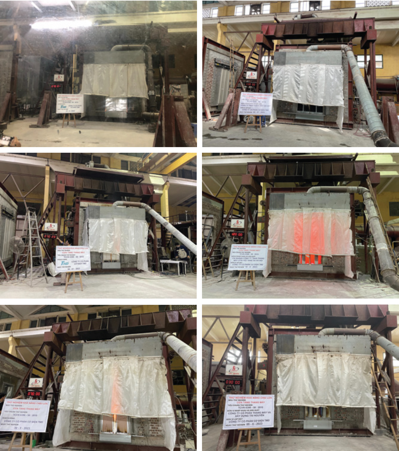
THỬ NGHIỆM ĐỐT MẪU CỬA TẦNG THANG MÁY EI, EI20, EI30, EI40, EI60, EI90
